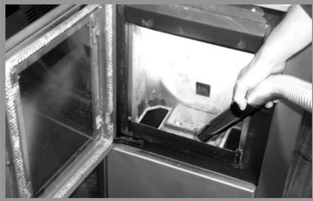
Abb. 12a: Reinigung des Brenntopfes
