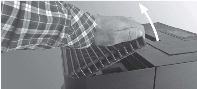
Der Brennraumdeckel bildet den Abschluss des Brennraums nach oben. Er muss demontiert werden, um die Reinigung der Heizgaszüge zu ermöglichen.
