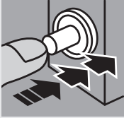
Abb. 3c: Betätigen des Piezo- Druckknopfes
