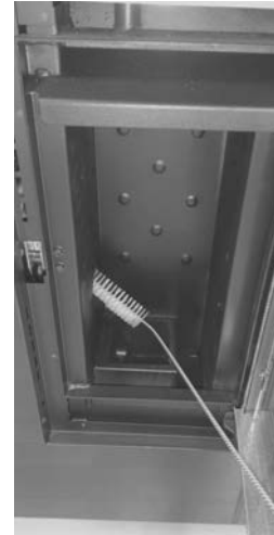
Fig. 36 - Reinigung mit Flaschenbürste
