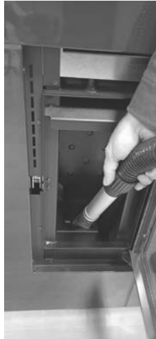
Fig. 35 - Reinigung Fach Brennschale
