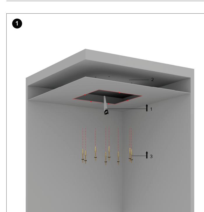
Für die Regenpaneele mit LED wird eine Leerrohrverbindung zur Digital Control der Duscharmatur Aquamotion benötigt.
