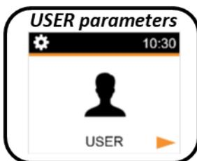
Die Auswahl des Parametereinstellungsmenüs erfolgt durch Drücken der **OK** Taste. Die Validierung erfolgt durch Drücken der Taste **▶**. Um das Parametermenü zu verlassen, muss der Benutzer den Parameter „QUIT“ wählen und die Taste **OK** drücken.
