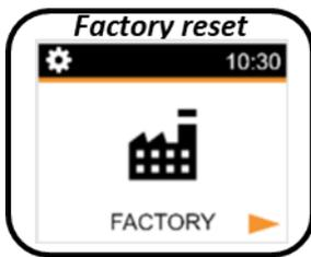
Alle Thermostatparameter werden mit den Werkseinstellungen geladen. Durch Drücken der **OK** Taste setzt das Thermostat seine Parameter zurück.
