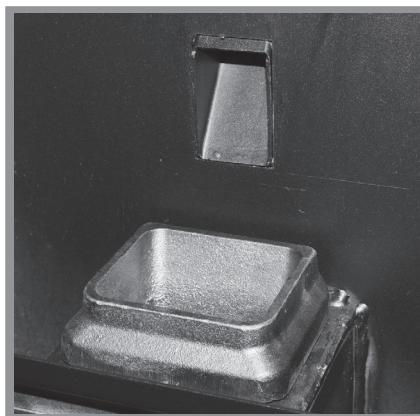
Abb. 6b: Richtig eingesetzter Brenntopf
