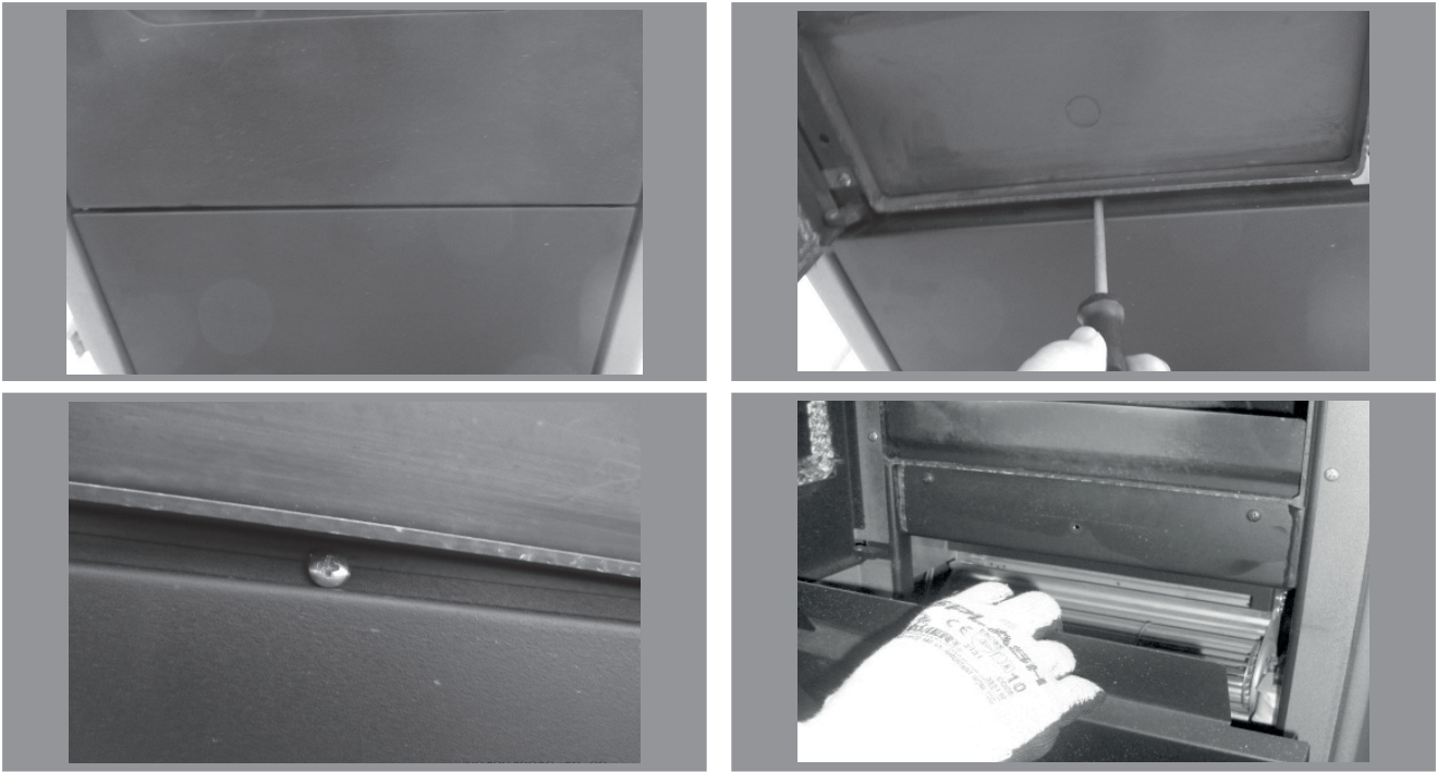
Abb. 13a: Öffnen der Frontplatte
