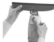
Obrázok 3: Montáž sacej hubice
