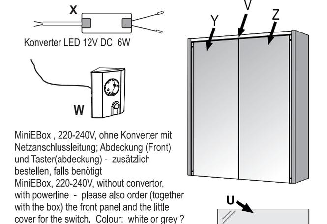
MiniEBox , 220-240V, ohne Konverter mit Netzanschlussleitung; Abdeckung (Front) und Taster(abdeckung) - zusätzlich bestellen, falls benötigt
