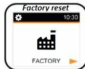
Alle Thermostateinstellungen werden auf die Werkseinstellungen zurückgesetzt. Drücken Sie dazu die Taste **OK**.
